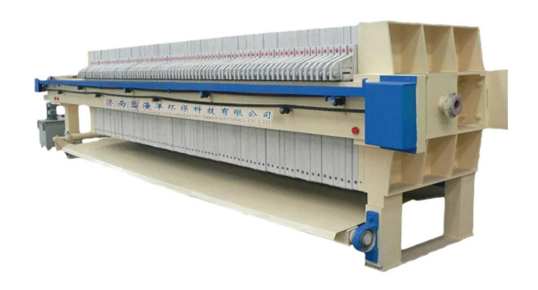
我公司研制生产的主导产品为防腐型压滤机,其设计科学,造型美观、通用性强、选材合理,坚固耐用,规格齐全。产品分为:自动、手动、厢式、板框式,其中滤板采用增强聚丙烯滤板,其过滤面采用点状圆锥凸台设计,模压成型,设计制造各种特殊性能压滤机,配置具有抗腐性的各种托盘的流槽。
