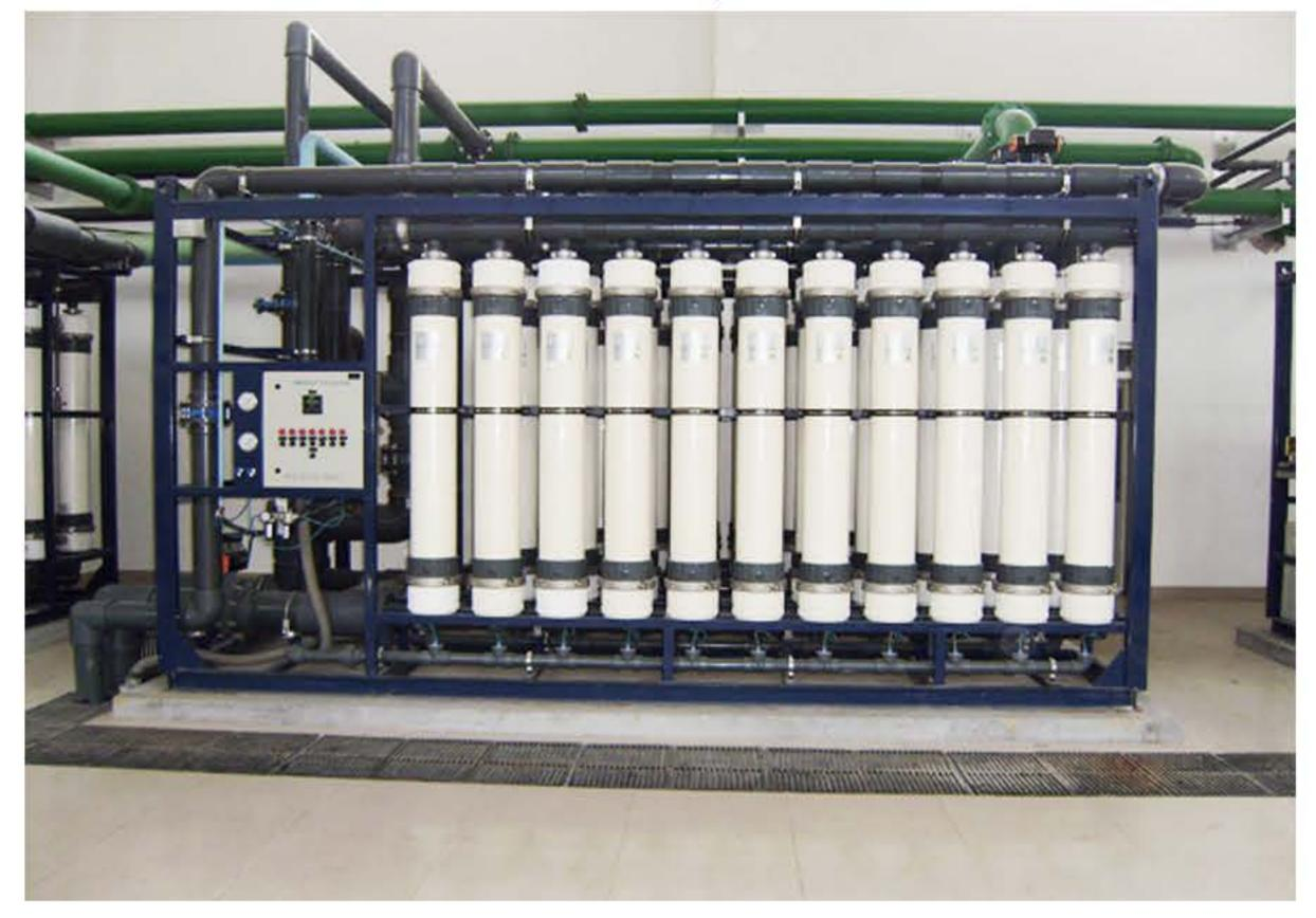
超滤净化装置可去除水中的悬浮物和胶体,同时去除原水中的高分子物质以及细菌、有机物等杂质,可直接用于工业用水或民用饮用水,也可串联到污水处理系统中,用于反渗透制纯水的原水。
