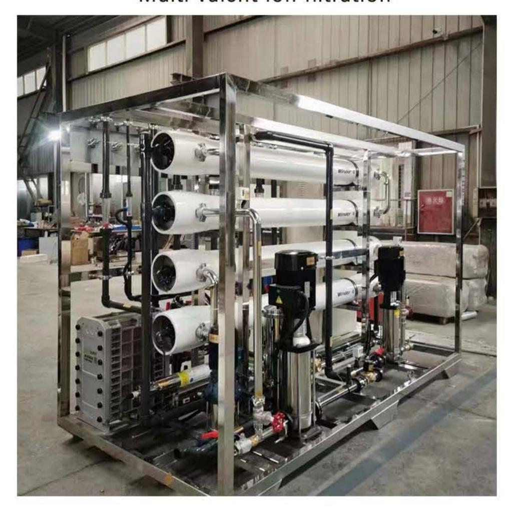
多价离子滤是在目前新兴技术膜技术的基础上,结合工业用自来水的相关技术要求,专业化更强的一种多价离子净化技术,适用于去除 Ca2+、Mg2+、Fe3+、Fe2+、SO42-、F- 达到优于自来水指标且替代自来水的标准。
