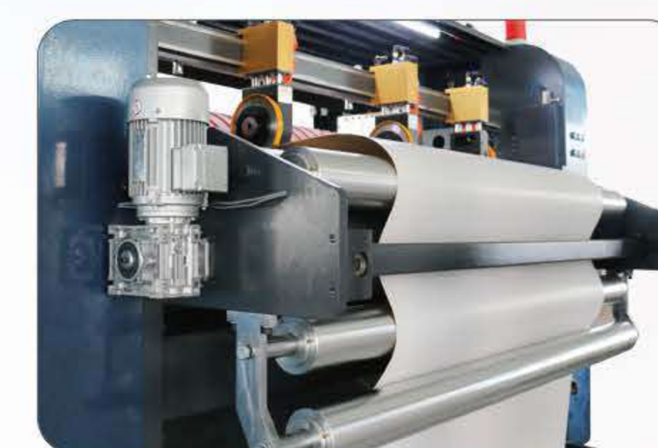
电动小反曲控制系统 Electric de-curl unit
