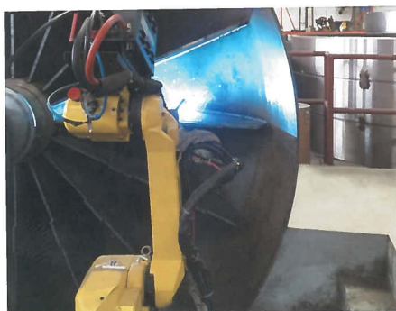
▲ 焊接1 Welding I
