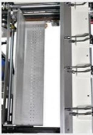
设计有专用模具车，装模轻松便捷，模具推入定位后，油缸迅速锁紧，减少更换模具的时间，更加安全可靠。
