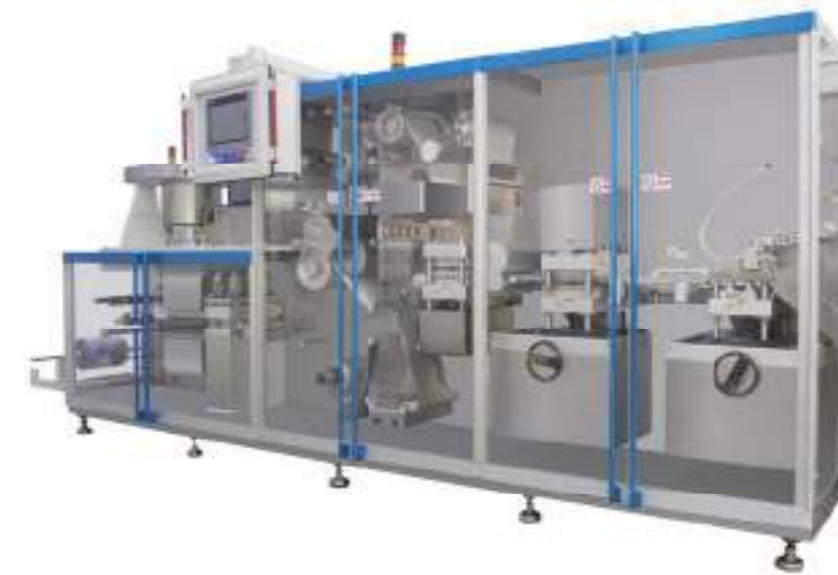
YS-DPF260 高速自动铝塑铝塑泡罩包装机 High Speed ALU-PVC-ALU /ALU-PVC(Tropical ALU) Blister Packaging machine
