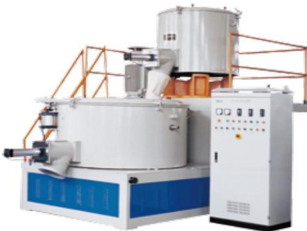
**特点及用途：**DYHL系列混料机组采用PLC控制，主要适用于各种树脂如聚乙烯、聚丙烯、聚氯乙烯等的配料、混合、着色、干燥，以及ABS、聚碳酸酯等工程塑料成型加工前的干燥，脱挥等工艺，也可用于酚醛树脂的混合。该机组将热与冷混工艺结合一起，完成热混的物料自动进入冷混使其冷却，排除残余气体，并可防止结块。
