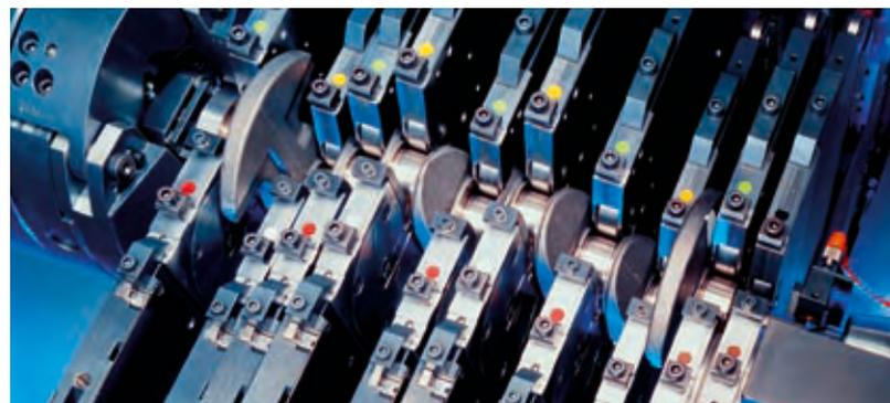
Festwalzen aller Haupt- und Hublager in einer Operation
