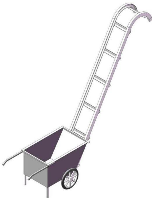
采用免挖坑挂车式提升机加料方式，物料车直接挂置在提升机上，手动控制，物料车上升自动翻转倒料，可避免物料中转的二次扬尘，操作方便，运行安全平稳。
