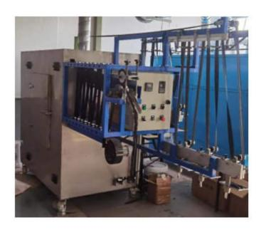
此机用于生产树脂拉链牙齿不同颜色的机器 将油漆涂在牙齿表面,进行封层处理,进入箱 体烘干,固化颜色 机器操作简单
