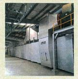
该系统是整个生产线的核心,它直接影响产品的质量与系统能耗,干燥窑内有多种调节及控制机构用来保证各部温度及气流均匀,使产品矿棉板烘干质量均匀、一致,并减少能耗。
