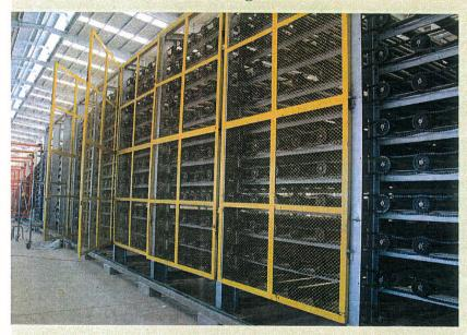
进板机与分配机的辊道以相同的速度接取 含水原板,并分别转换成慢速(即窑速),将 湿板送入烘干窑进行连续烘干。
