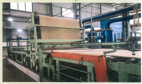
湿板坯带由高压水力切割切成一定的长度和宽度,横向切割与长网机成一定角度。按照程序,定尺切割。
