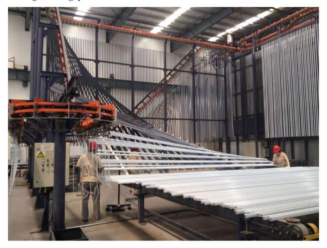
说明:采用最新型输送平台,平台采用二套传动装置,一套为链条传动,一套为毛毡带传动,二套同步运行。工件放置在毛毡带上,有效防止工件划伤,保证工件表面质量。毛毡带底部为链条传动,输送台上工件重量为链条承载,完全杜绝输送台上工件过多而致使输送带打滑。主传动采用同轴启动设计,保证了工件在输送过程中保持一致。
