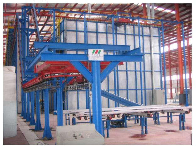
1、**说明**:悬挂输送机系统由驱动装置、张紧装置、牵引链条、十字轨道、一次挂具、 支撑件、自动加油机等组成。
