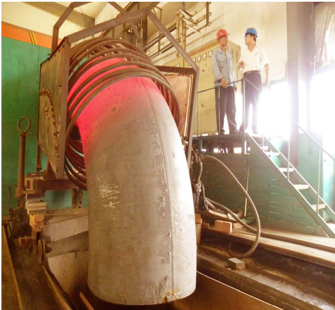
沧海重工自主研发的 1600T 特大弯头推制机:加工能力 DN500-1200
