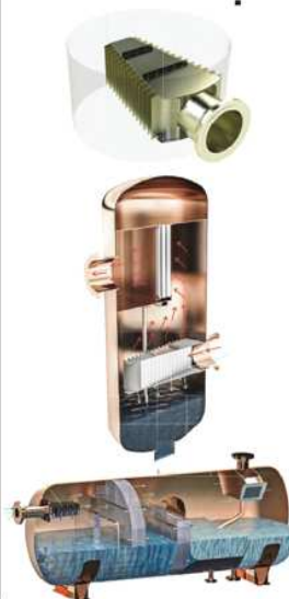
تجهیزات داخلی جداکننده ها
