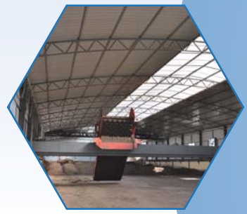
槽宽可达20米,无须移行,操作便捷效率高,节省占地面积和建筑成本。 Fermentation channel width up to 20 m for saving construction cost .
