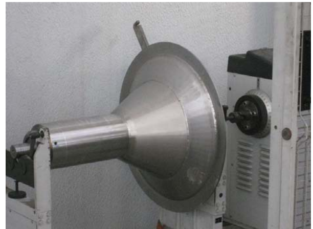
EQUILIBRATURA DINAMICA DEL DISCO DEFLETTORE DYNAMICALLY BALANCING OF SPLASH DISC
