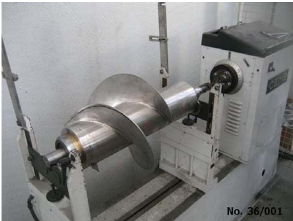
EQUILIBRATURA DINAMICA DELLA GIRANTE DYNAMICALLY BALANCING OF IMPELLER
