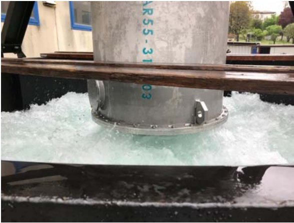
Miscelatore in prova Testing the mixer
