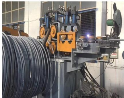
**压线校直装置Press straightening device**
